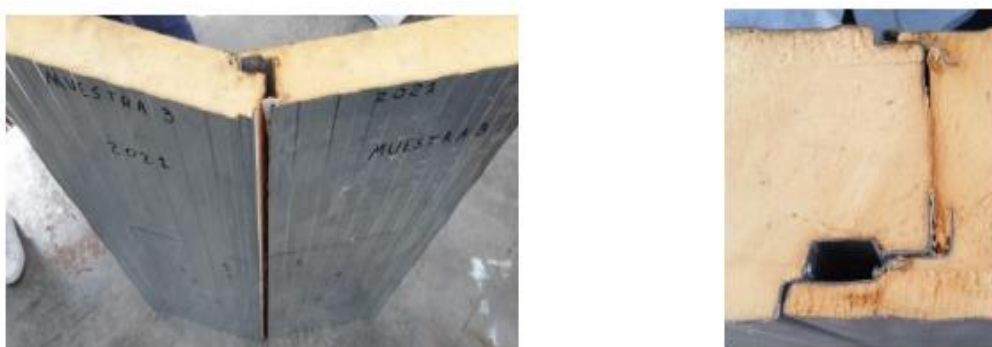
Figura 8: Muestra 3 después del ensayo en el H-TRIS. Sin alteración del sistema.
