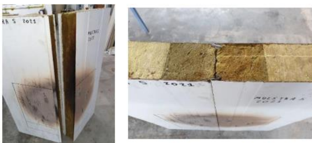
Figura 13: Muestra 5 luego del ensayo en el H-TRIS
