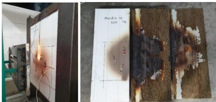
Figura 16: Muestra 10 Se observa la presencia de llamas en el interior del panel por la existencia de adhesivo combustible y la falla de la junta.
